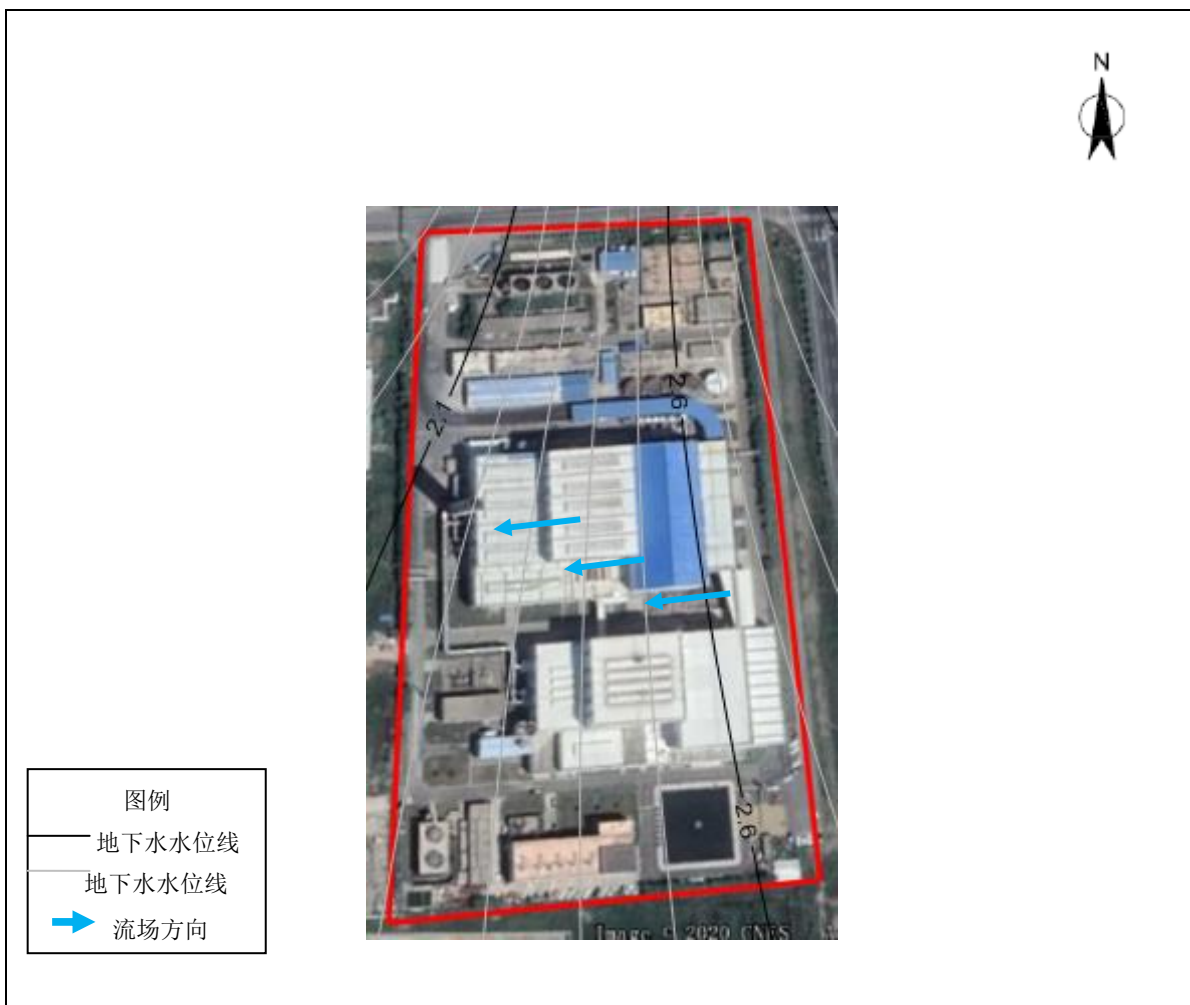
图 5.1-2 地下潜水流场（等水位线）图
